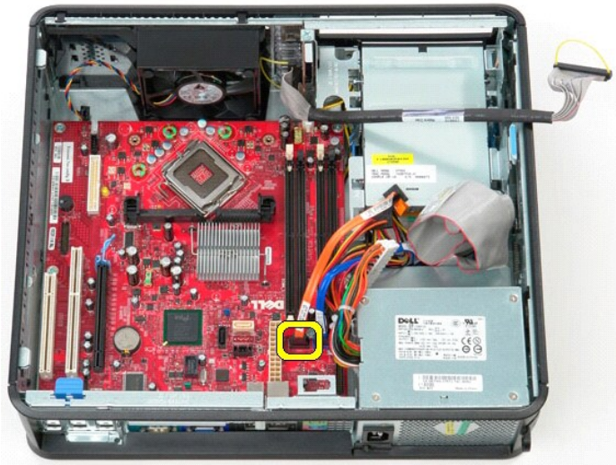
01. افصل كابل بيانات محرك الأقراص الضوئية عن لوحة النظام.
