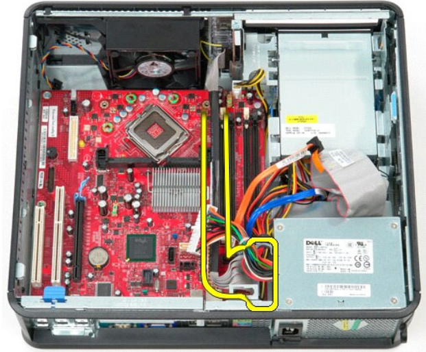
01. افصل كابل بيانات محرك الأقراص الضوئية عن لوحة النظام.
