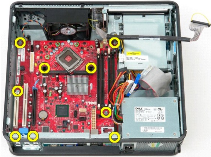
41. قم بإزالة حامل مجموعة وحدة امتصاص الحرارة من الكمبيوتر.
